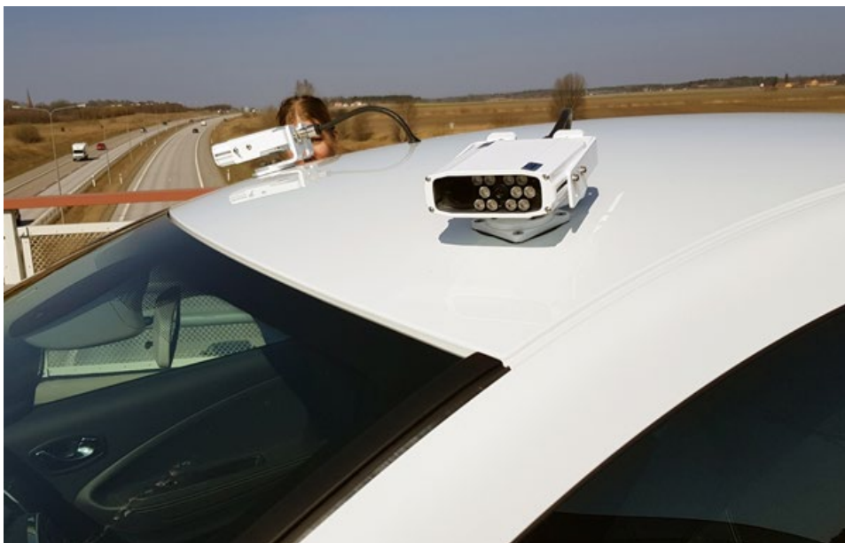
Bolagets scanningbil har takmonterade kameror för elektronisk avläsning av registreringsskyltar.
